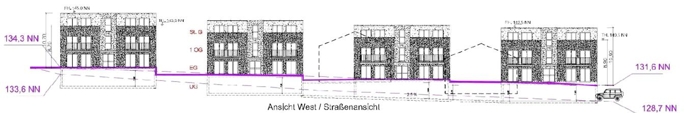
Die Gebäuden Höhenlage ist an Straßenhöhenverlauf angepasst
