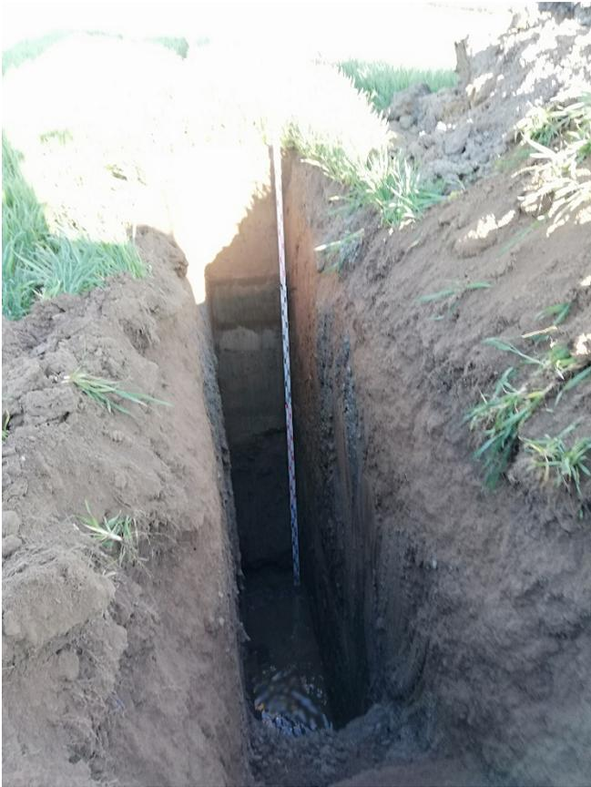
Bild 9: Baggerschurf SCH 4 bis in rd. 3 m u. GOK – Wasser ab 2,8 m u. GOK
