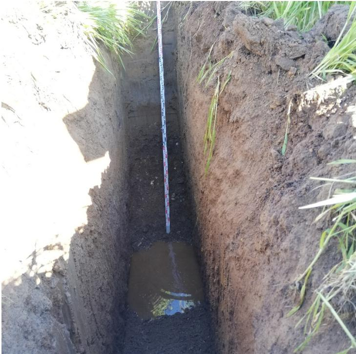
Bild 1: Baggerschurf SCH 1 – Wasserzutritt bei rd. 2,8 m u. GOK
