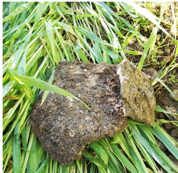
Bild 2 + 3: Schurf SCH 1 – Aushubmaterial der Flusskies und verkittete Kiese
