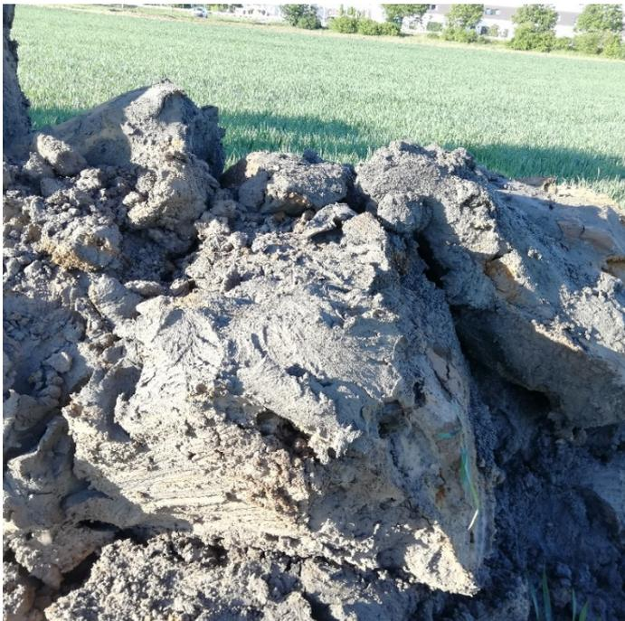
Bild 10 + 11: Schurf SCH 4 – Aushubmaterial: grauer weicher Auelehm ab 2,3 m u. GOK
