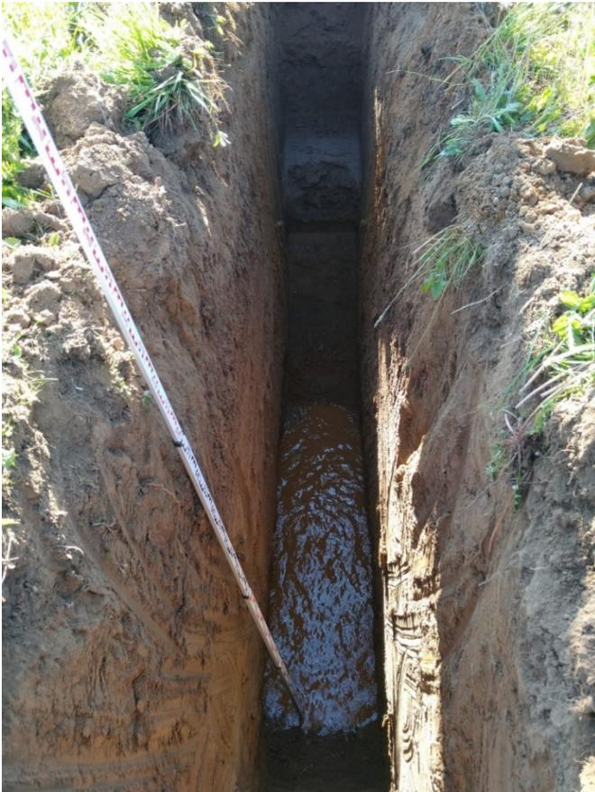
Bild 7: Baggerschurf SCH 3 bis in rd. 4 m u. GOK – Wasser ab 3,6 m unter GOK
