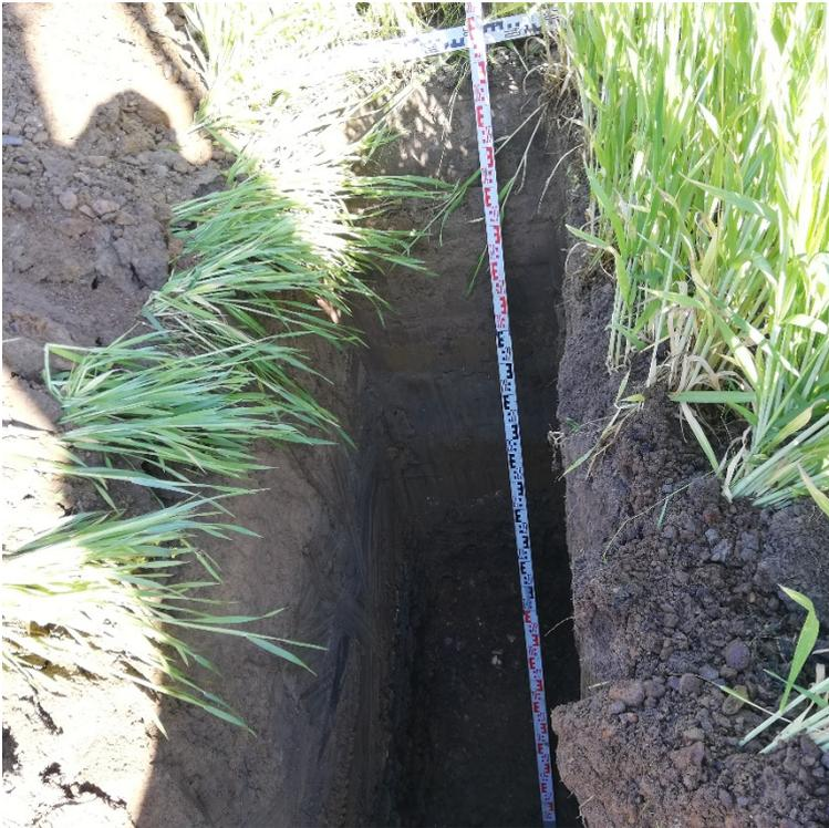
Bild 4: Baggereschurf SCH 2 bis in rd. 3 m u. GOK – Wasser in 2,6 m unter GOK
